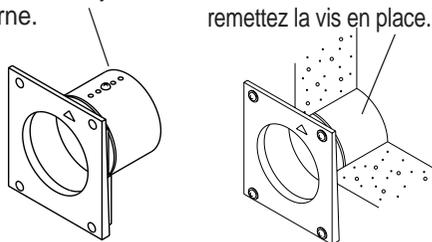
Imperméabilisez le dégagement entre le manchon et le trou du mur avec un scellant à température élevée.
