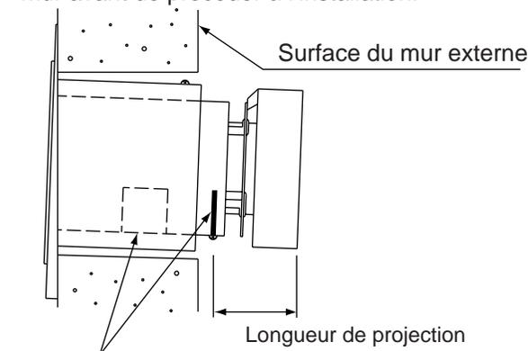
La ligne rouge doit être visible. Le rectangle rouge ne doit pas être visible de l'extérieur.
