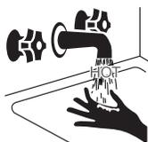
Une température de l'eau chaude du chauffe-eau supérieure à 125°F peut provoquer instantanément de graves brûlures ou la mort suite à un ébouillantage.
