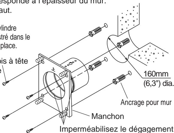
Imperméabilisez le dégagement avec un scellant à température élevée.
