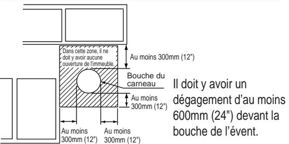
• Cette restriction ne s'applique pas dans une zone où une protection efficace maintient un dégagement d'au moins 600mm (24") en face de la sortie d'échappement.
