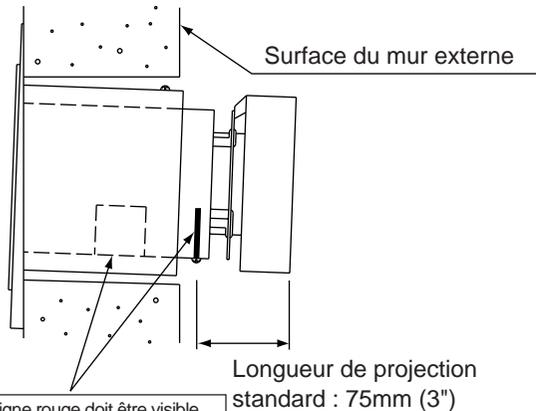
La ligne rouge doit être visible. Le rectangle rouge ne doit pas être visible de l'extérieur.
