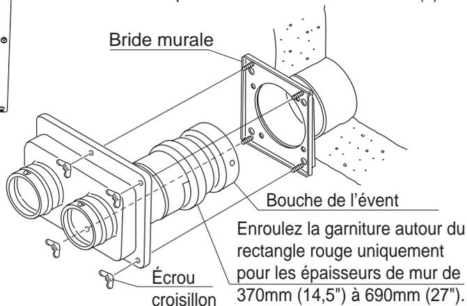
\* Le modèle d'installation (3) est à l'origine d'un dégagement entre la bouche de l'évent et la surface du mur. Bouchez ce dégagement avec un scellant à température élevée.
