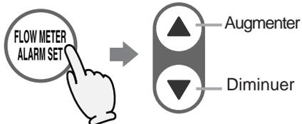
Choisissez le réglage de l'alarme du débitmètre parmi les options suivantes : 38 – 260 L (10 - 60 gallons) (Par intervalle de 20 L (5 gallons)), 300 L (80 gallons), 340 L (90 gallons), 380L (100 gallons), 990 L (262 gallons)
