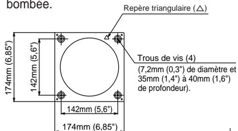
Avant d'installer le manchon, ajustez sa longueur pour qu'il corresponde à l'épaisseur du mur. (La longueur peut être ajustée par palier de 10mm (0,4").)
