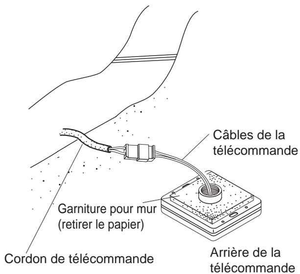
3. Retirez le couvercle de la télécommande, marquez l'emplacement des trous de vis et percez les trous pour les ancrages pour mur.
