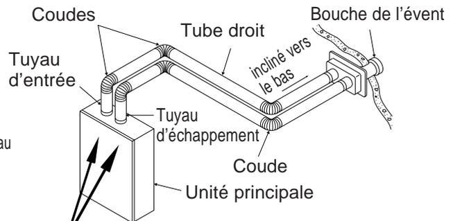
Utilisez un adaptateur d'évent de la catégorie III pour raccorder le collet du carneau au système de ventilation. Utilisez un tuyau d'évent de catégorie III sur toute la longueur du tuyau d'échappement.
