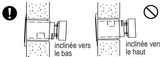
3) Installez avec une longueur de protubérance à travers le mur appropriée.
