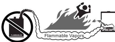
**Les vapeurs de liquides inflammables exploseront et prendront feu provoquant la mort ou de sévères brûlures.**
